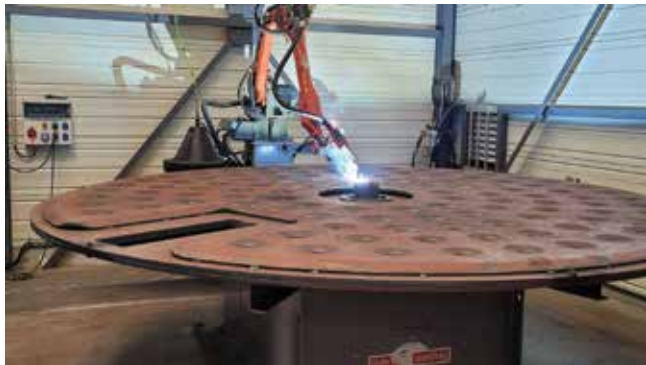
Obr. 1 Bunka dokončí každý špirálový zvar za štyri a pol minúty. (Foto ©: Valk Welding)
